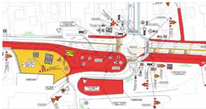
Križišče Jelen - začasna prometna ureditev
