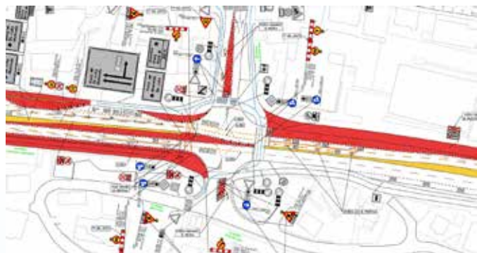
Križišče Galant - začasna prometna ureditev (zavijanje samo desno)
